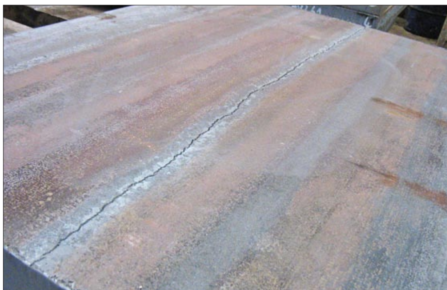
Slika 3: Globoka vzdolžna razpoka z izvorom v kokili na kontinuirno ulitem slabu
