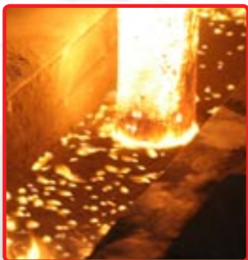
Talina nato teče iz vmesne ponovce v kristalizator kontiliva.
