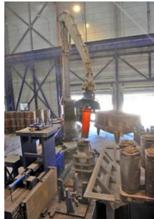
Stripanje ingotov z mobilnim strojem
