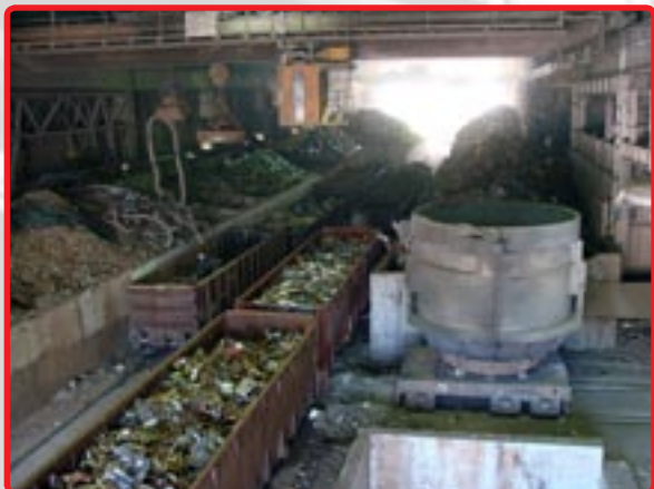
Skladišče jeklenega odpadka; na levi je zakladalna ali šaržirna košara, v katero se naloži jekleni odpadek.
