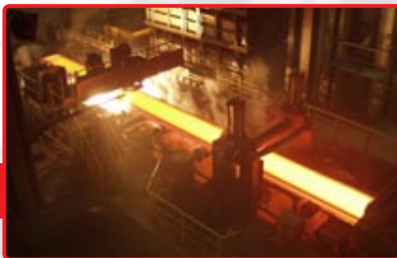
Začne se ulivanje jekla, katerega rezultat je jeklena žila, ki se izvleče iz kontilivne naprave.
