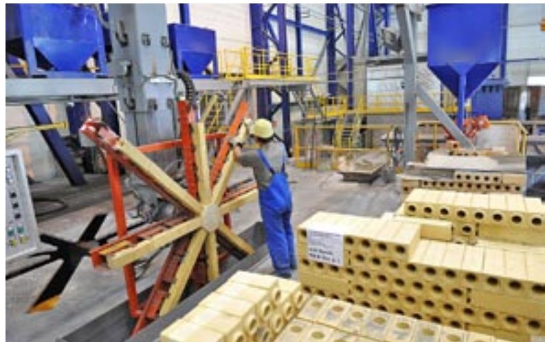
Zidanje livne plošče – priprava kanalske opeke
