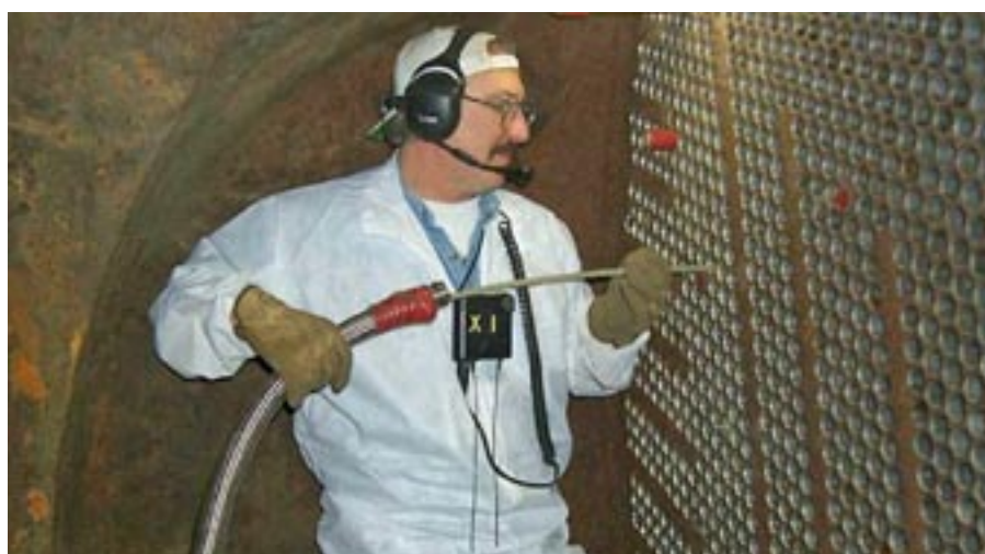
Slika 4: Preverjanje izmenjevalcev toplote
