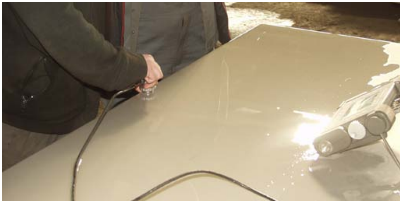
Ultrazvočni pregled kakovosti nerjavne debele pločevine
