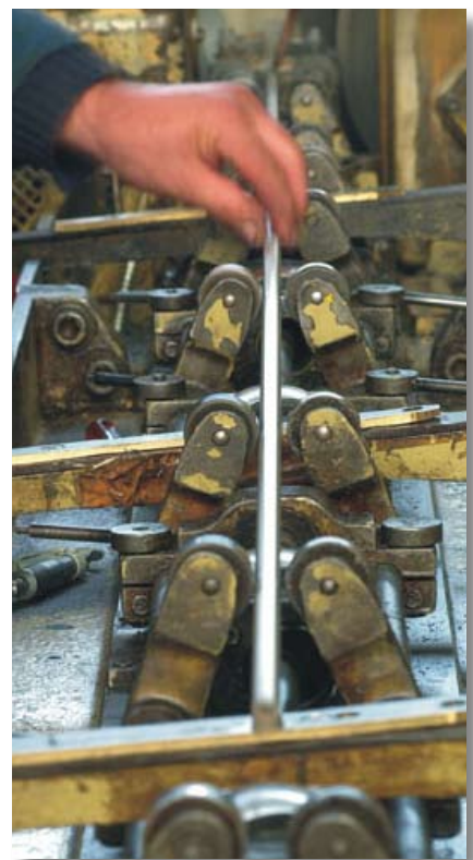
Brušenje palic v Metalu Ravne
