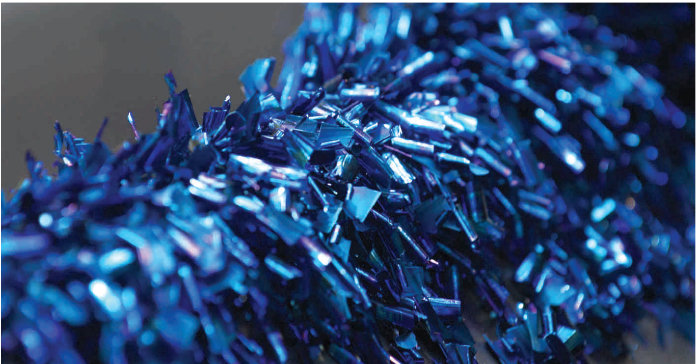
Odrezki od rezkanja pri obdelavi nožev – enkrat mesečno se ponovno pretopijo v jeklo.
