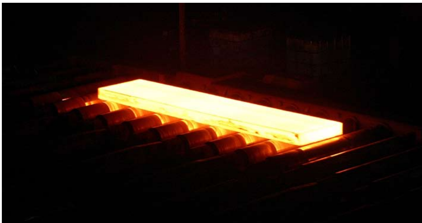
Acronijeva »zlata plošča«: Iz potisne peči potuje ogreti slab (širok 1 m, dolg 6 m in debel 200 mm) po valjčnicah do valjalnega ogrodja (bluming)
