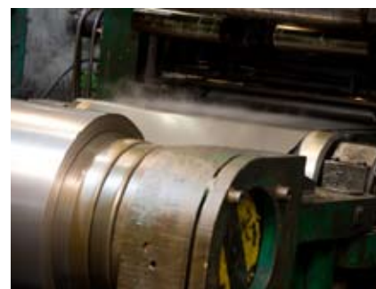
Hladno valjanje traku na valjalnem ogrodju Sendzimir
