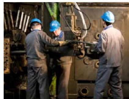
Menjava delavnih valjev na valjalnem ogrodju Sendzimir
