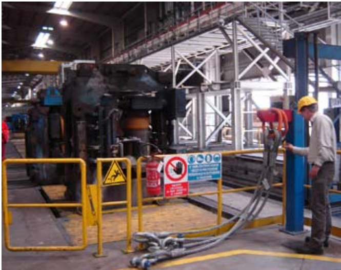
Prehod s pohodnih površin na delovna mesta ter ustrezno urejena in označena pomožna nosilna sredstva
