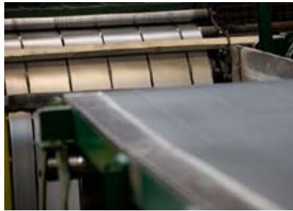
Razrez kolobarjev hladno valjanega traku
