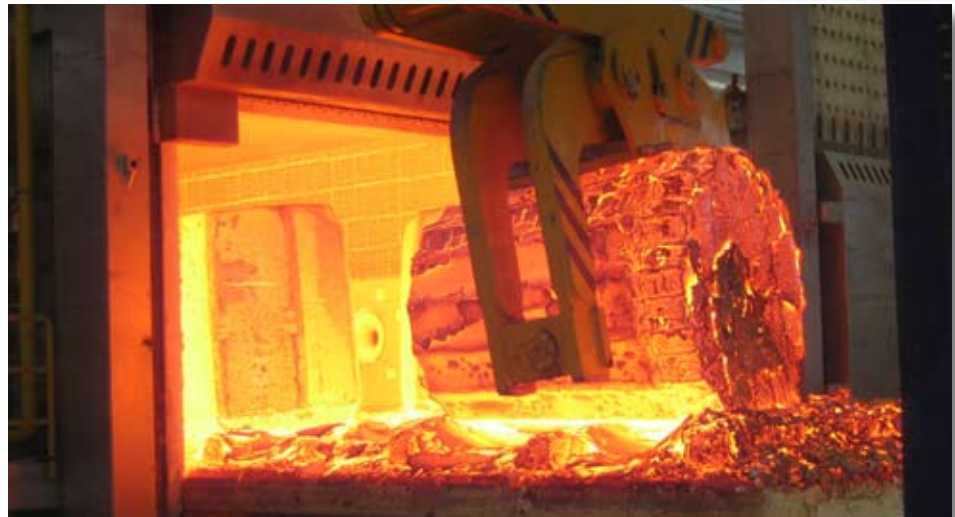
Prenos 35-tonskega ingota iz ogrevne kovaške peči
