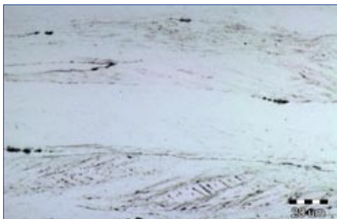
Slika 4: Feritna zrna (vlakna) hladno valjanega traku debeline 0,35 mm
