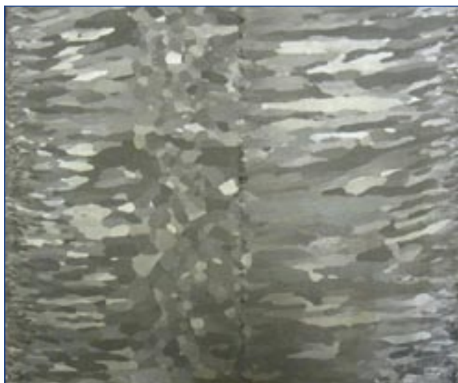
Slika 1: Feritna zrna ulite brame elektropločevine debeline 250 mm
