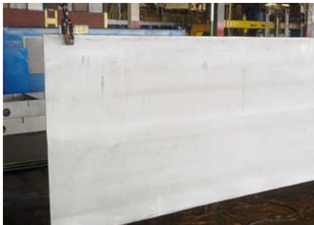
Končna plošča nerjavne debele pločevine iz martenzitnega nerjavnega jekla 410, pripravljena za odpremo
