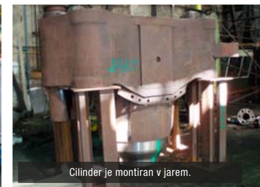
Odkovek smo zvarili in obdelali v Serpi.
