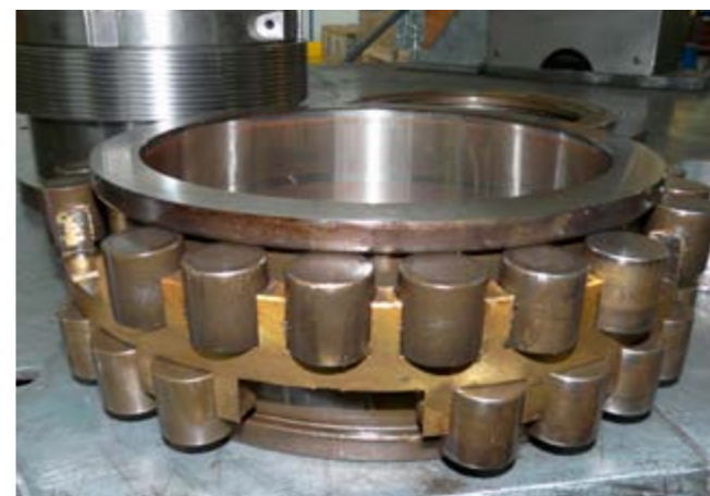
▶ Poškodovani glavni ležaj – polomljena kletka
