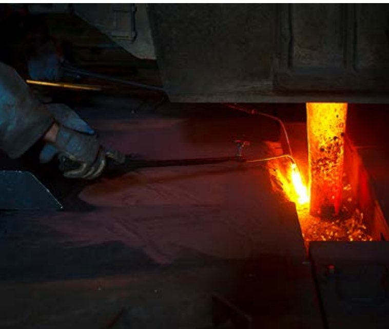
• Ulivanje in strjevanje taline v vodno hlajeni kokili kontinuirne naprave
