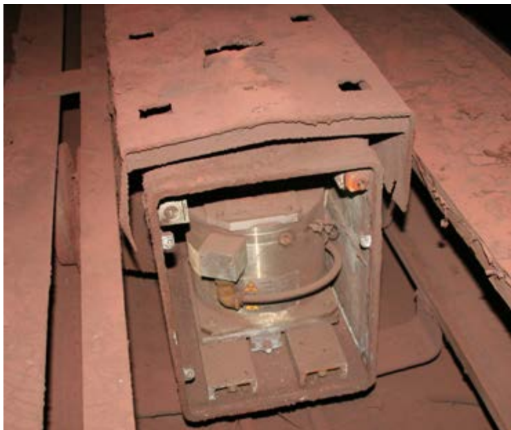
▲ Ohišje z vsebnikom znotraj spodnje roke C-okvirja
