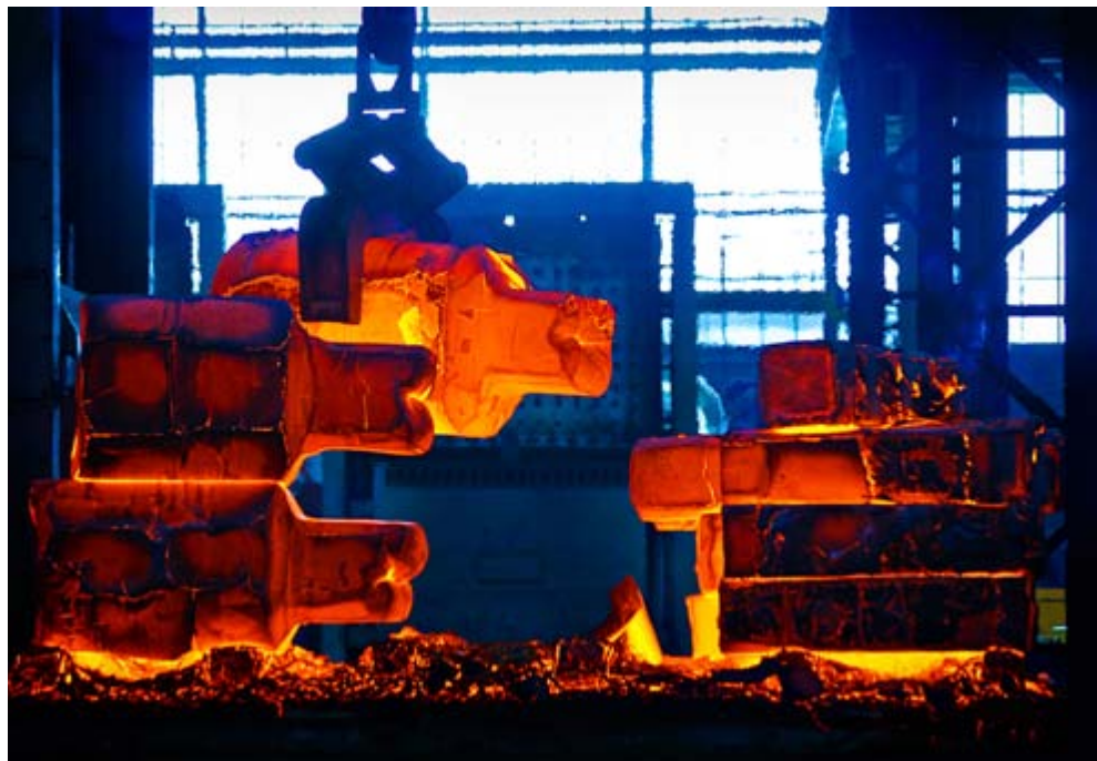
▲ Transport ingota na stiskalnico v kovačnici Metala Ravne
