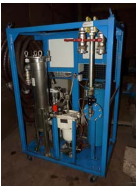
● Modra naprava je filtrirna, rumeno-rdeča pa sušilna naprava.
