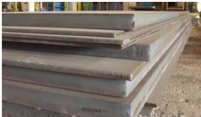
• Obrezane orodne plošče po zaključni toplotni obdelavi
