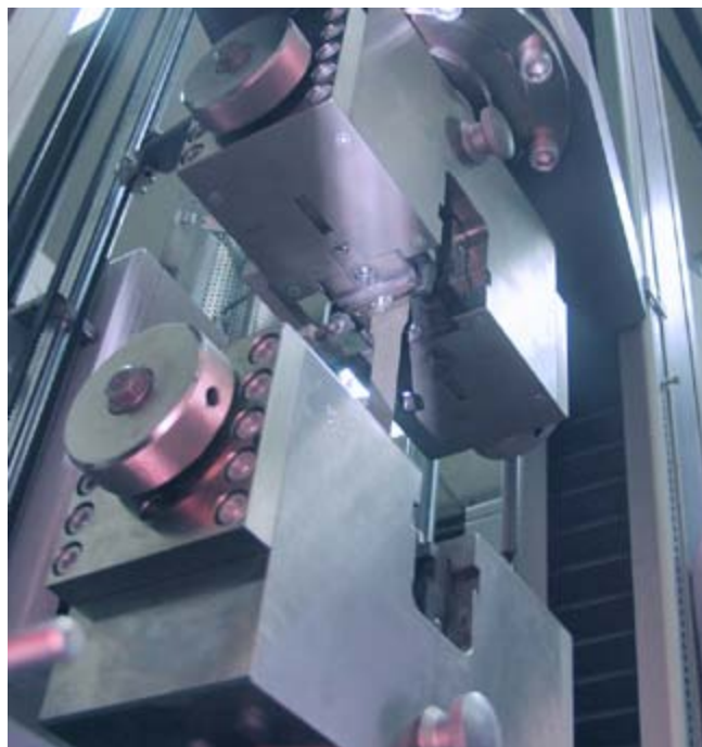
▲ Trgalni stroj med izvajanjem nateznega preizkusa
