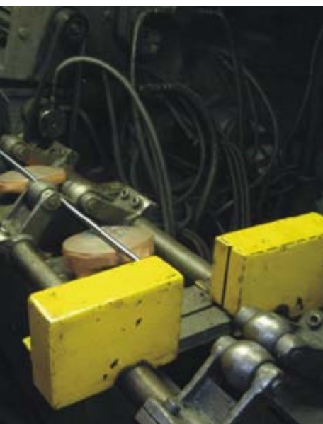
Merilne laserske glave na izhodni strani brusilnega stroja
