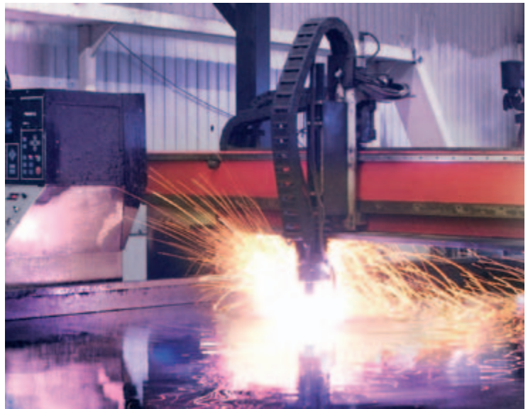
● Plazemski razrez pod vodo do dimenzij 3,5 m x 7,5 m in debeline 80 mm
