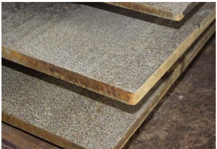
► Debeli pločevina iz zlitine Invar, predelana v Acroniju
