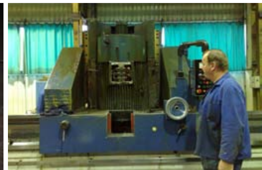
▲ Brusilni stroj je že delno razstavljen.
