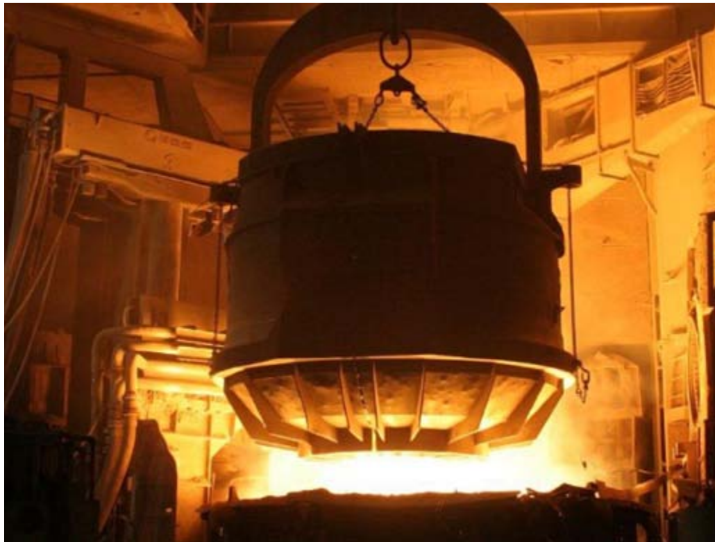
■ Iz zakladalne košare se strese jekleni odpadki v elektroobložno peč.
