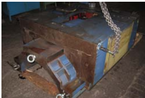
▲ Vodila obdelovalne glave brusilnega stroja se zaradi omejenega pomika neenakomerno obrabljajo.
