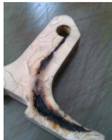
▲ 60 kV preboj skozi nosilec anode
