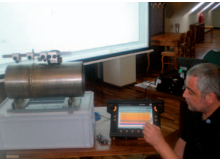
• Demonstracija delovanja ultrazvočne naprave USM Vision Thomas Fausten
