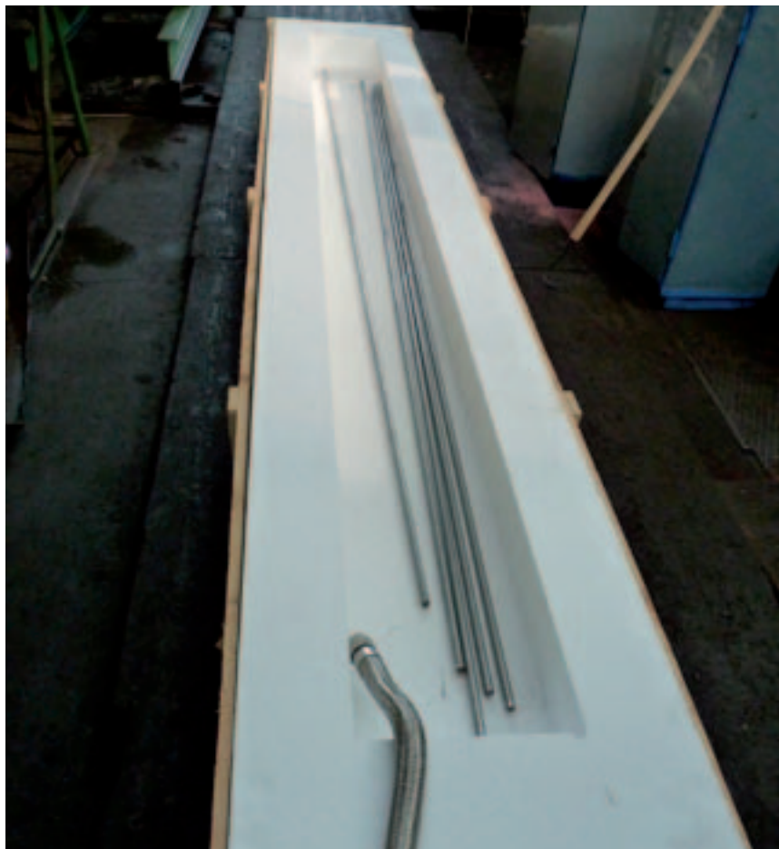
Podhlajanje palic v tekočem dušiku
