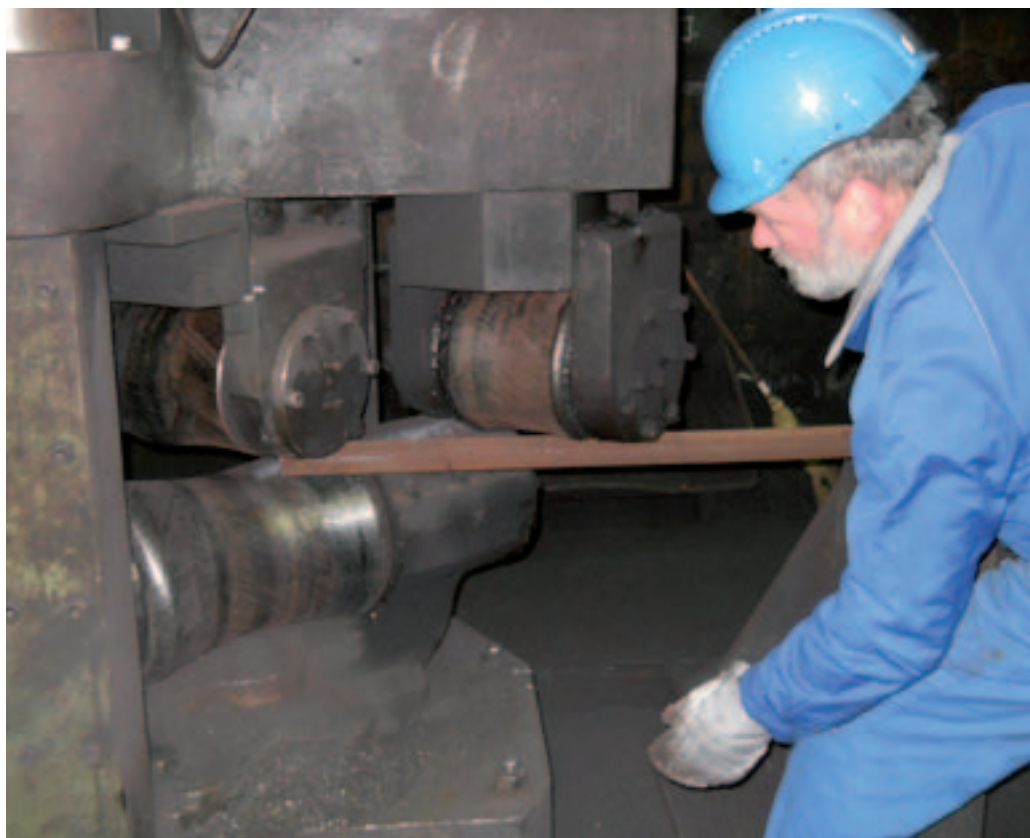
Uvajanje valjanega profila med ravnalne valje pred posodobitvijo
