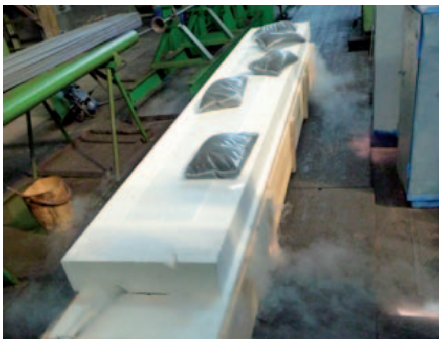
Banjica za podhlajevanje palic
