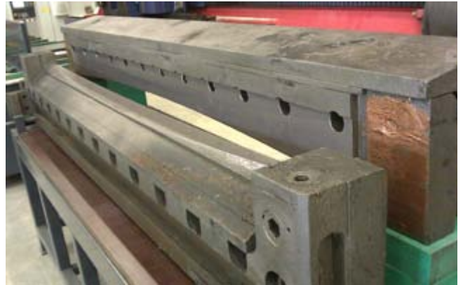
• Kaseta z noži za razrez debele pločevine v toplem po obnovitvi
