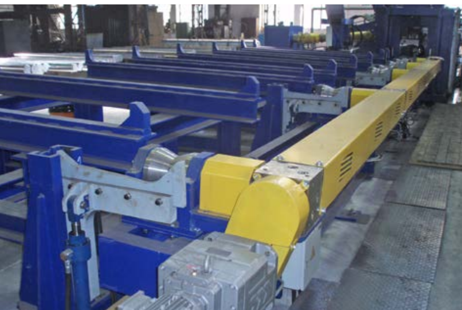
▀ Dovodna valjčna miza v Mehanski obdelavi kovačnice
