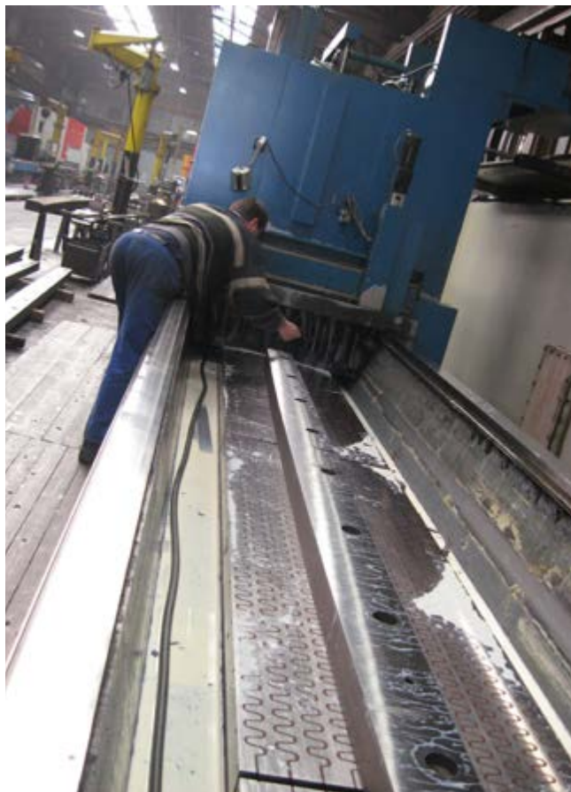
Vmesno merjenje pri brušenju debeline noža na končno dimenzijo
