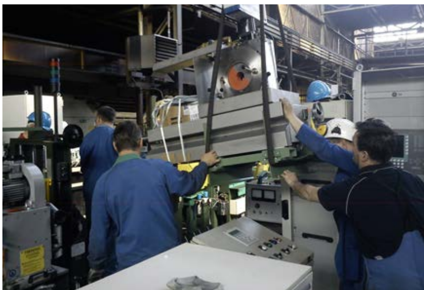
▲ Mehanizem z UZ-glavami pred vgradnjo v linijo
