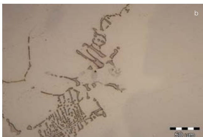
▶ Slika 1: a) Evtetik NbC – \gamma sredinskega dela kontinuirno ulitega slaba, b) povečana NbC - \gamma z vidno dodatno fazo v sredinskem delu posnetka.
