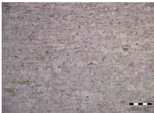
▶ Slika 2: Končna mikrostruktura po toplotni obdelavi sredinskega dela plošče debeline 63,5 mm v smeri valjanja: a) nejedkana mikrostruktura z vidnimi ostanki primarnih NbC, b) elektrolitsko jedkana mikrostruktura z do 100 \mu m velikimi avstenitnimi zrni ter majhno količino \delta – ferita.
