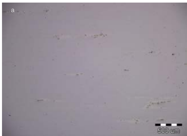
▶ Slika 2: Končna mikrostruktura po toplotni obdelavi sredinskega dela plošče debeline 63,5 mm v smeri valjanja: a) nejedkana mikrostruktura z vidnimi ostanki primarnih NbC, b) elektrolitsko jedkana mikrostruktura z do 100 \mu m velikimi avstenitnimi zrni ter majhno količino \delta – ferita.
