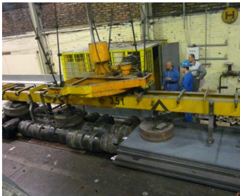
Tehtnico smo polno obremenili – do njene končne nosilnosti 30.000 kg.
