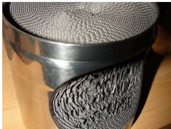
● Presek – izsek katalizatorskega navitja iz Acronijevega jekla
