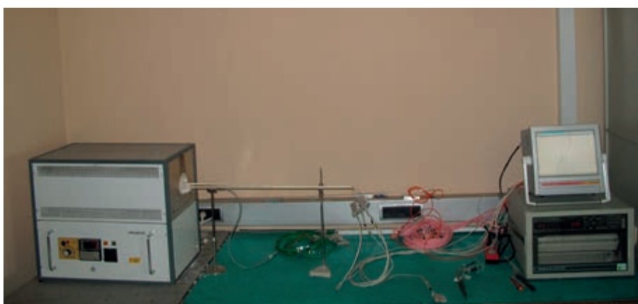
• Velika skupina meril so termoelementi, s katerimi spremljamo temperature v peči. Kalibriramo jih sami v oddelku Termoregulacije.
