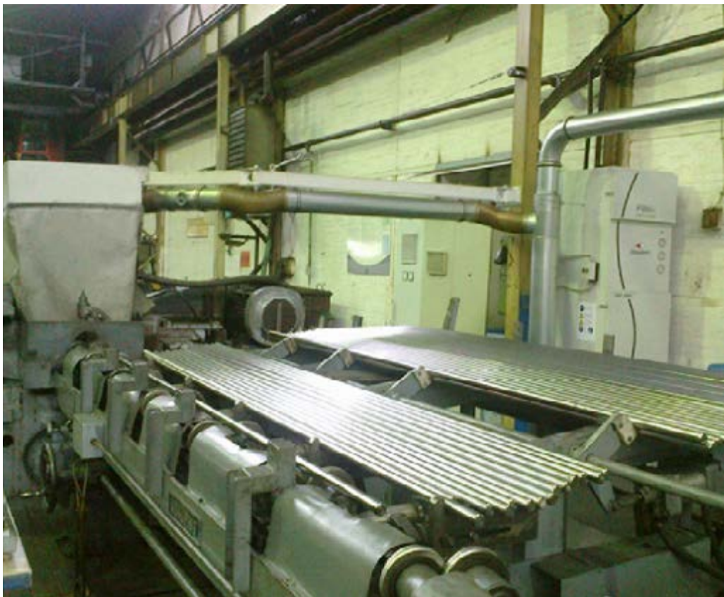
▶ Priklop odsesavanja oljne megle na brusilnem stroju na nov sistem v Proizvodnji svetlih profilov
