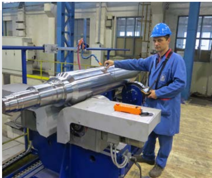
▲ Gabor Sekereš iz Metala Ravne med UZ-kontrolo valja
