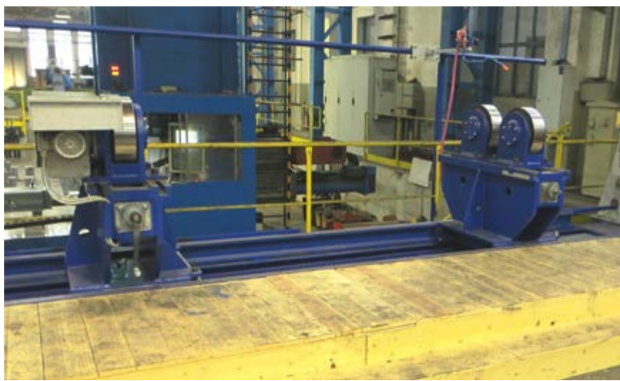
▲ Stroj za središčenje in UZ-kontrolo valjev v mehanski obdelavi Serpe
