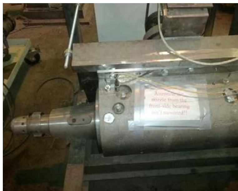
▶ Vreteno na nosilni konstrukciji
