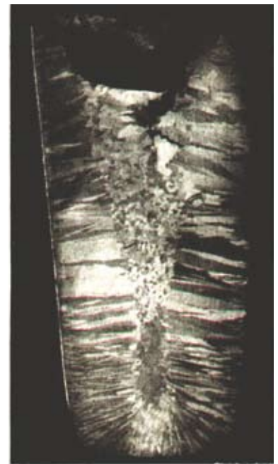
Slika 6: Kristalizacija ingota, odprti lunke pri glavi ingota
