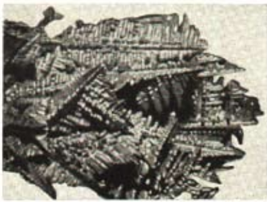
Slika 4: Dendriti jekla, ki so prosto rasli v območju lunke, povečava 5 : 1
