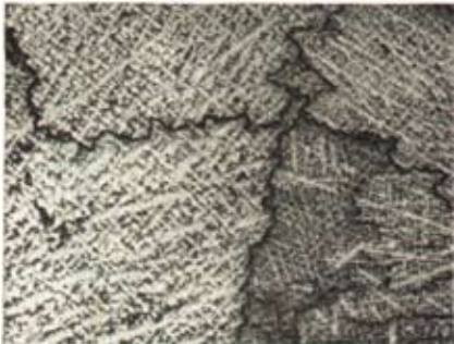
Slika 3: Dendritna struktura litih kristalnih zrn jekla, legiranega z manganom, povečava 10 : 1
