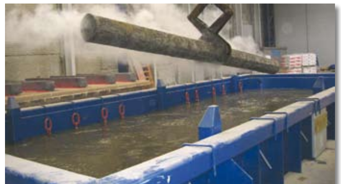
Med potapljanjem se kljub intenzivnemu mešanju v bazenu odkovek počasi, a vztrajno ohlaja.
