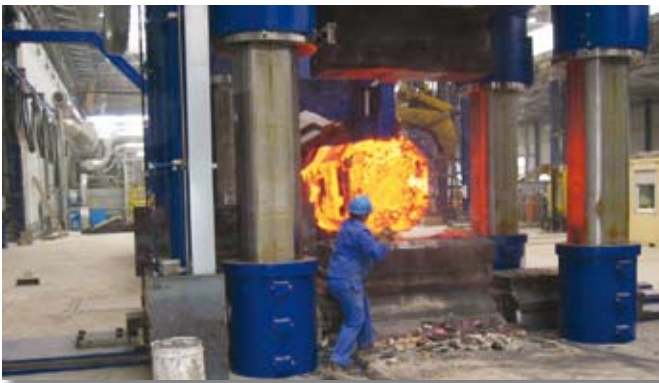
Med kovanjem je treba odpadno škažo sproti čistiti z orodja. Težka je borba z vročino.
