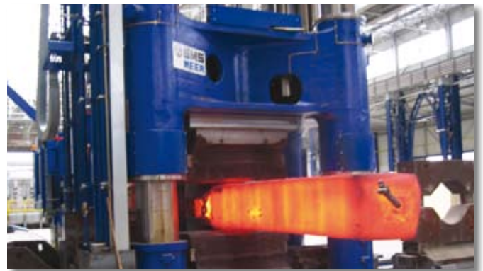
Kovanje se uspešno zaključuje, odkovek dobiva končno podobo.
