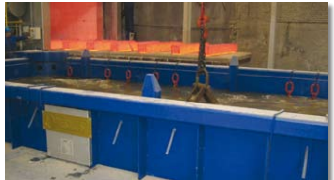
Prvi poskus izvajanja toplotne obdelave v polimernem bazenu. V skrbi za ekologijo smo kalilno olje zamenjali s polimerno mešanico. Odkovek na prvem hlajenju, mešanje je zelo intenzivno.
