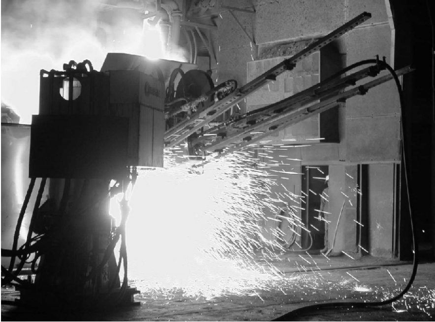
Naprava za vpihanje kisika in ogljika v elektroobložno peč
