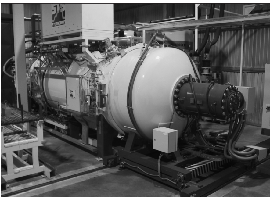
Vakuumska peč omogoča kaljenje širokega spektra jekel, tudi jekel, ki so kaljiva samo v olju
